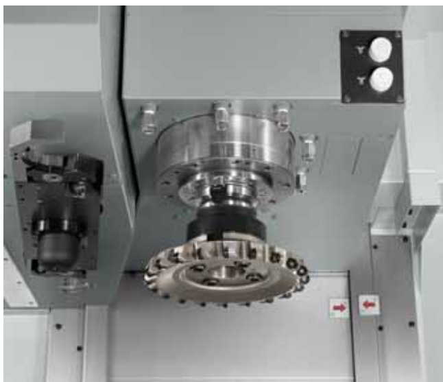
Abb. 2. Kegelspindel Nr. 50 (mit \varnothing 240 mm Planfräser)
