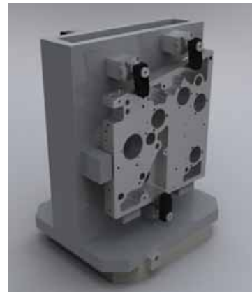
図 4. 加工事例 (印刷機のフレーム)
